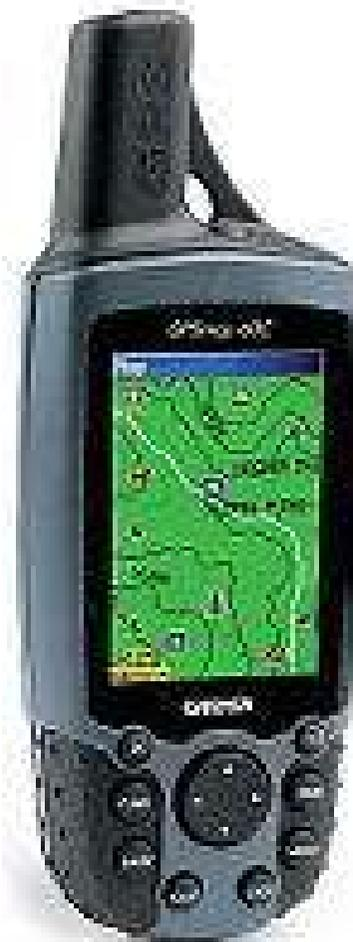
Il funzionamento del GPS si basa sulla misura del tempo di percorrenza del segnale trasmesso dall'antenna del satellite fino all'antenna del ricevitore-utente a terra.
