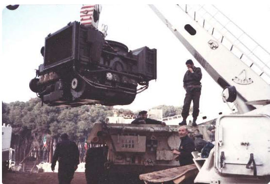
Libano 1983 – Scavalco gruppo motopropulsore con carro soccorso Leopard
